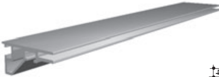
Rahmenprofil für 3mm Flach-Keder profile for frames and 3mm flat keder, 1000mm - 990g, Herstellungslänge 6050mm production length is 6050mm
